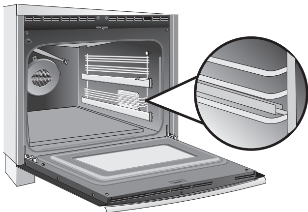
Figura 17: Soportes de rejilla de escalera
