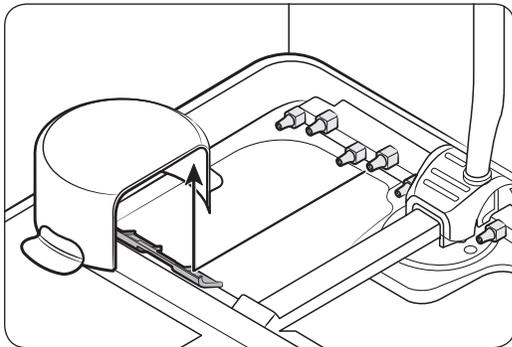
Pour un nettoyage plus efficace, placez les objets volumineux du côté gauche du panier inférieur, dans la Zone Booster. La fonction Zone Booster active des jets d'eau puissants dans la Zone Booster. Assurez-vous que les poignées des chaudrons ou des casseroles n'empêchent pas la rotation des gicleurs et du réflecteur d'eau.
